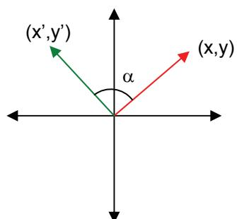
Drehung um den Nullpunkt mit Drehwinkel  $\alpha$ .
