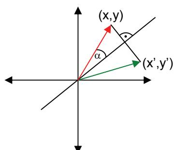
Spiegelung von Vektoren an der Geraden durch 0 mit Winkel  $\alpha$ .
