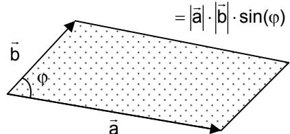
$$\begin{pmatrix} a_1 \\ a_2 \\ a_3 \end{pmatrix} \times \begin{pmatrix} b_1 \\ b_2 \\ b_3 \end{pmatrix} = \begin{pmatrix} a_2 \cdot b_3 - a_3 \cdot b_2 \\ -a_1 \cdot b_3 + a_3 \cdot b_1 \\ a_1 \cdot b_2 - a_2 \cdot b_1 \end{pmatrix}$$
